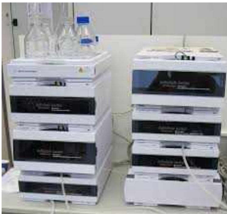
სურათი 25. Agilent 1260 სერიის მაღალეფექტური სითხური ქრომატოგრაფი.
